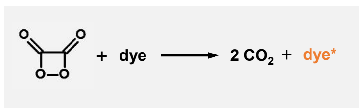
光る棒の中で起きている反応
